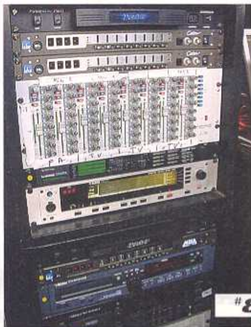
8 Le rack de contrôle en régie façade avec la matrice Midas, les deux égaliseurs Lake Control, le Finalizer et l'analyseur de spectre. C'est de là que partent les envois aux différents points de la diffusion.
