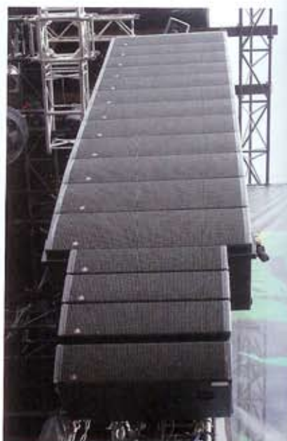
Das Line-Array bestand aus Y18- und Y10-Lautsprechern von Adamson
