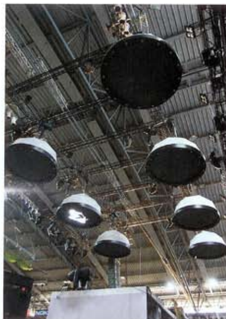
Die Kreiskonstruktionen sind mit Barco-OLite-510-LED-Modulen bestückt.
