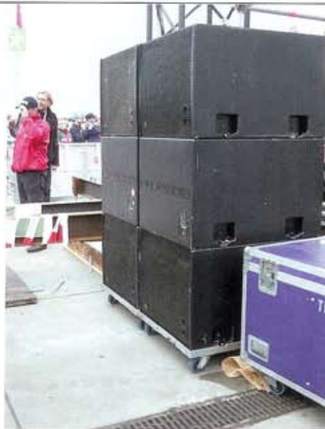
Sub-Konfiguration bei den Delay-Towern für reduzierte Überlappungen mit der Front-PA, im Hintergrund A. Weingärtner
