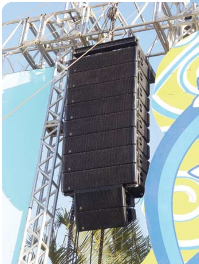
Detalhe do line array Adamson, com modelos Y10 e SpecTrix Wave
